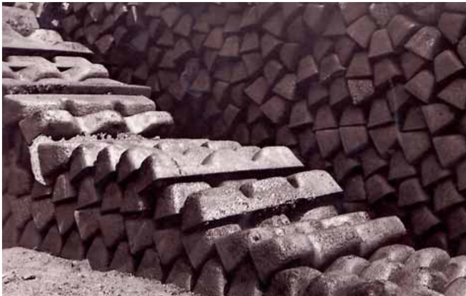
In Formen gegossene Eisenmasseln (Hugger, Paul, Der Gonzen: 2000 Jahre Bergbau 1991)
